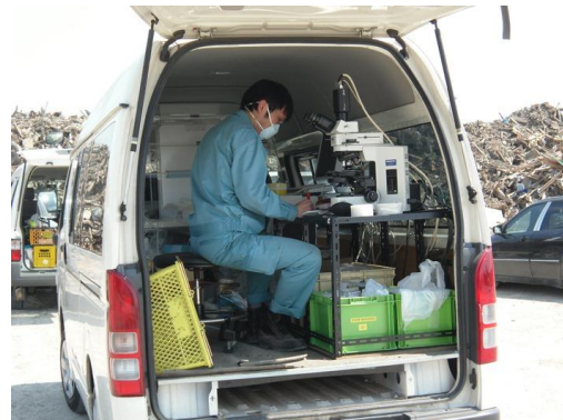
アスベスト分析用「MOVING LAB」による 現地調査風景(4/14撮影)
